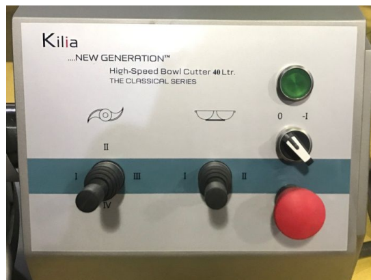
Panel con palitos de alegria para una operacion sencilla
