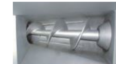
Конический шнек конвейера
